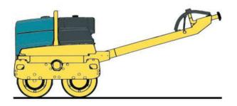
2 fréquences de vibration : 55 / 60 Hz
